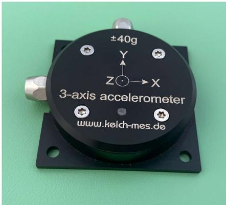
Dieser Sensor misst Beschleunigungen in den 3 Raumkoordinaten und gibt die Messergebnisse in einer CAN-Botschaft aus. Das Sensorelement ist in einer mikromechanischen Siliziumstruktur gefertigt und realisiert von rein statischer, bis zu 1KHz dynamische Messungen mit hoher Auflösung. Die Datenausgabe auf dem CAN-Bus kann kundenspezifisch angepasst werden.
