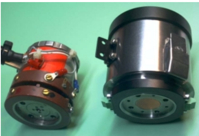
Bild 7: Bildhafter Größenvergleich zu einem HBM-Schleifringübertrager SK6
